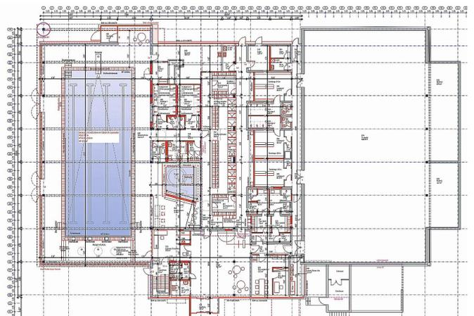
Abb. 1 – Beispielhafter Grundriss – in Rot gekennzeichnet alle Bauteile mit Änderungen
